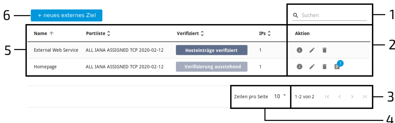
Abb. 4.2: Aufbau von Listenseiten
